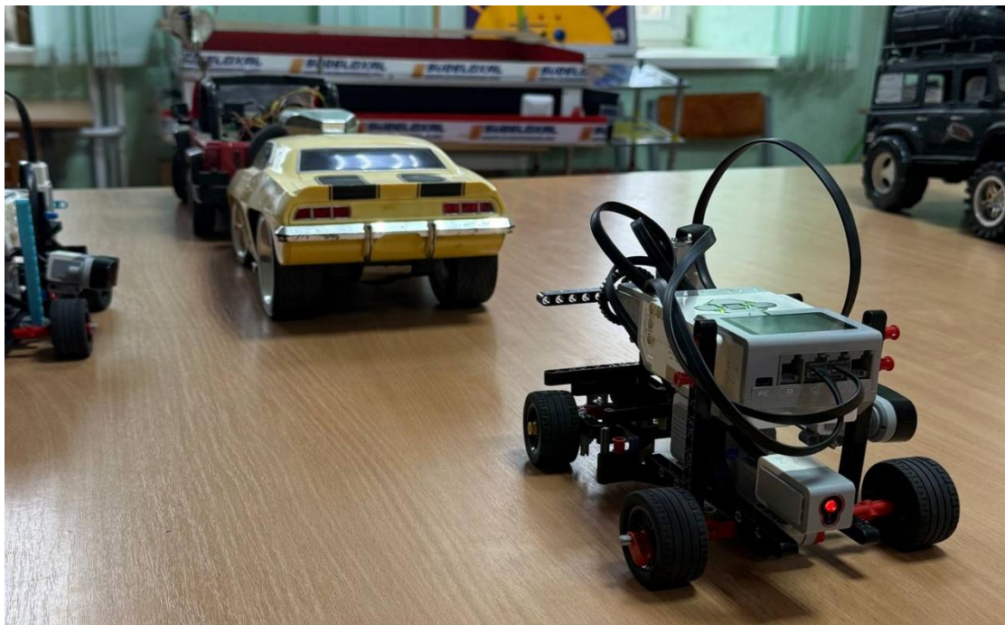
Рис. 2. Модель робоавтомобіля та її успішне фінальне паркування в межах визначеної вільної зони після роботи алгоритму програми.
